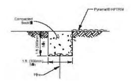
Figure 3. Longitudinal edge trench detail.
