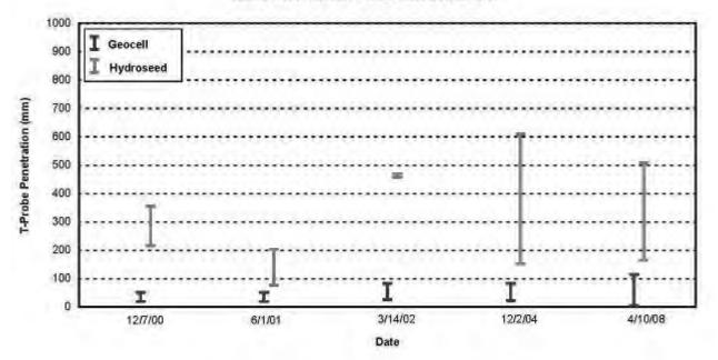
SLOPE MONITORING "PULSED" T-PROBE MEASUREMENTS
