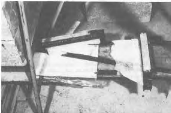
Fig. 7 Nontissé de fibres continues thermosoudées après essai dynamique. Energie 50 J.
