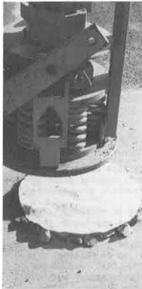
Fig. 4 - Mise en place du géotextile avant application de la charge
