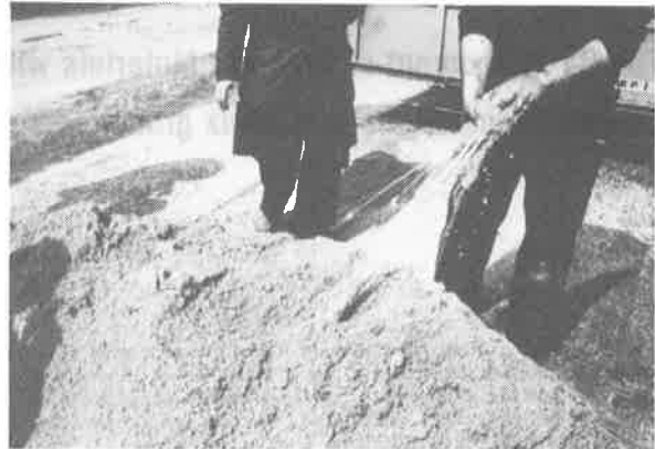
Figure 2 - Volume de sable traité à faible dosage (environ 0,5 pour mille). Fils tirés de la masse.
