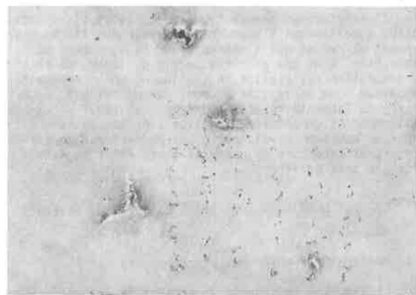
Fig. 6 - Perforations d'un nontissé obtenues par l'essai de simulation
