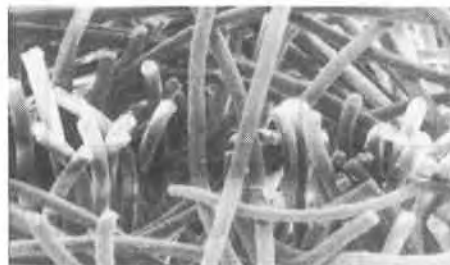
Fig. 7 Rupture des points d'aiguilletage après exposition prolongée.
