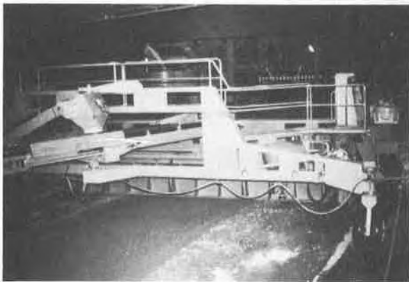
Figure 6 - Vue de la machine d'épandage des matériaux du Centre d'Expérimentations Routières de Rouen (Ponts et Chaussées).
