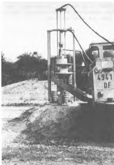
Figure 4 - Test à la dynaplaque d'une masse traitée. Test with the "Dynaplaque" of a treated sand mass.
