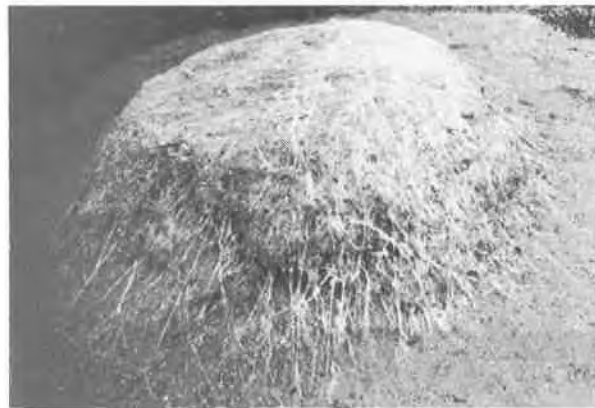
Figure 5 - Masse de sable traité ayant subi une attaque de 20 minutes au jet d'eau.
