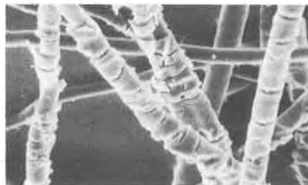
Fig. 8 Rupture des points de thermosoudage après exposition prolongée.
