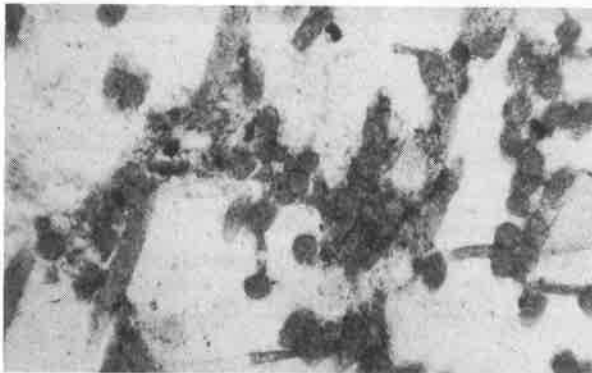
Fig. 3 Détail agrandi d'un colmatage interne : ponts interfibres et formation d'amas.
